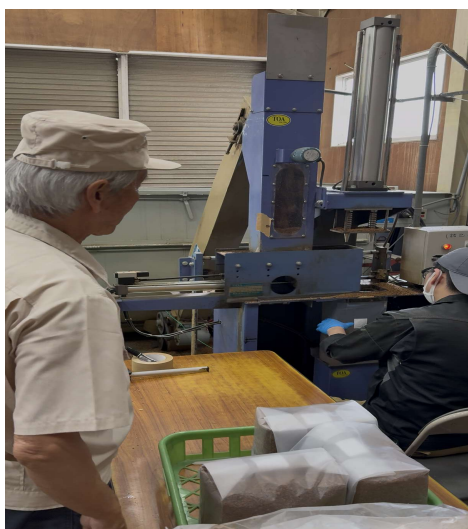
攪拌後袋への詰め作業の様子
